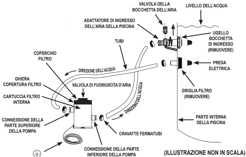
Il filo elettrico che collega la pompa filtro alla presa di corrente a 220-240volt, deve restare a minimo 3,5m dal bordo piscina. Controllare le normative locali per determinare gli standard e i requisiti per "l'installazione dei dispositivi elettrici relativi a piscine e vasche". La seguente tabella è solo indicativa.
