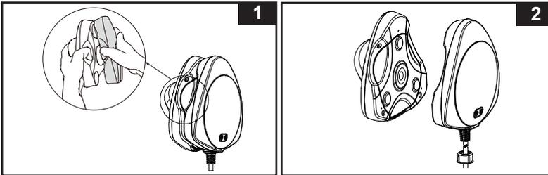
2. Posizionare il trasmettitore (2) sulla parte esterna delle pareti della piscina e la luce (1) sulla parte interna della parete, quella sommersa dall'acqua. Assicurarsi che le aste magnetiche del trasmettitore siano allineate correttamente con le aste magnetiche della luce. Vedi disegni (3).
