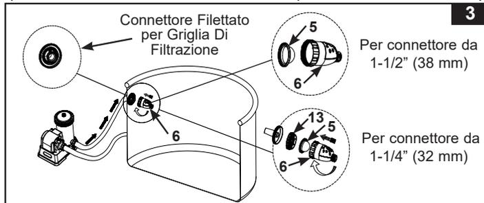
4. Dal lato interno della piscina, fissare il raccordo di prolunga del filtro a griglia (12) sopra il filtro a griglia dell'uscita di aspirazione. Vedi fig. 4.
